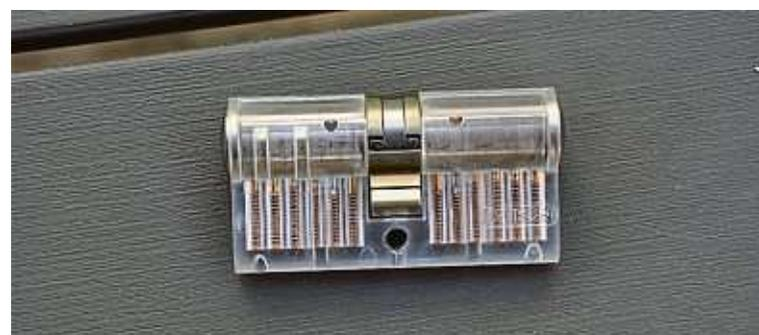
Mit feinen Abtastwerkzeugen öffnen Nils Trexler und Sirius Schmidt (links) die Schlösser. Die Werkzeuge werden in Sets verkauft und nach Schlossgröße angepasst eingesetzt. Gut zu erkennen sind in dem durchsichtigen Schloss die Schließstifte.
